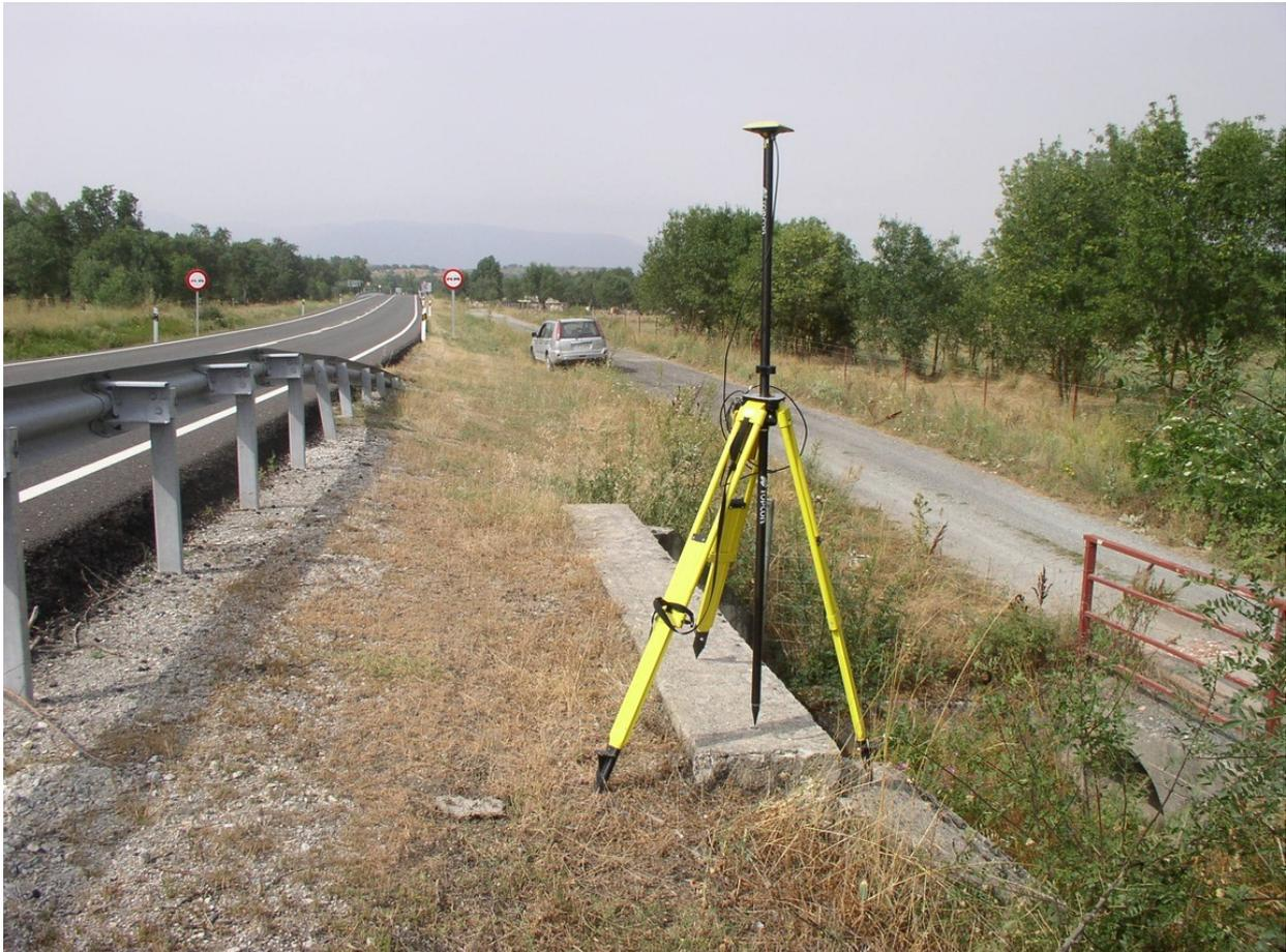
*Fig. 4: Estacionamiento en señal NAP n° 24 -Linea 813, pk. 153.8 de N-110*
