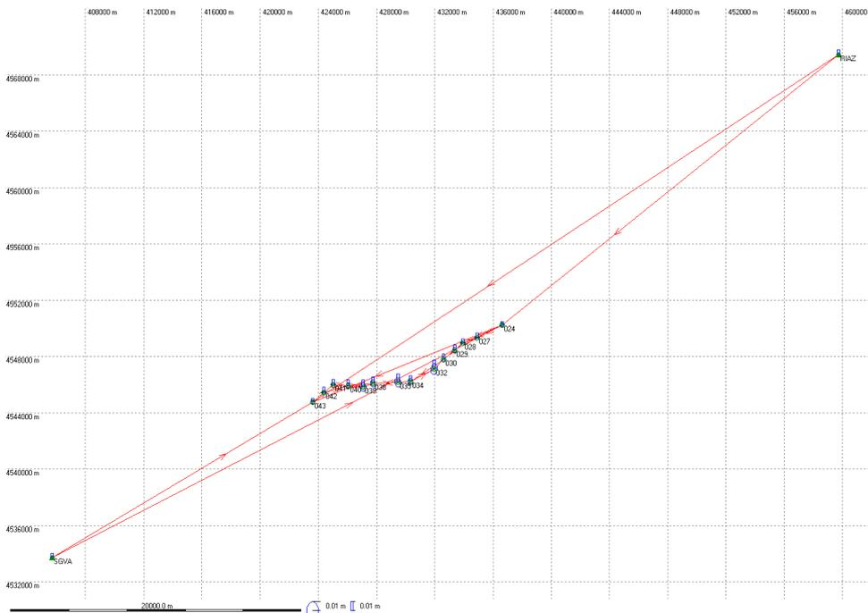
Fig. 3: Líneas base conexión a marco referencia
