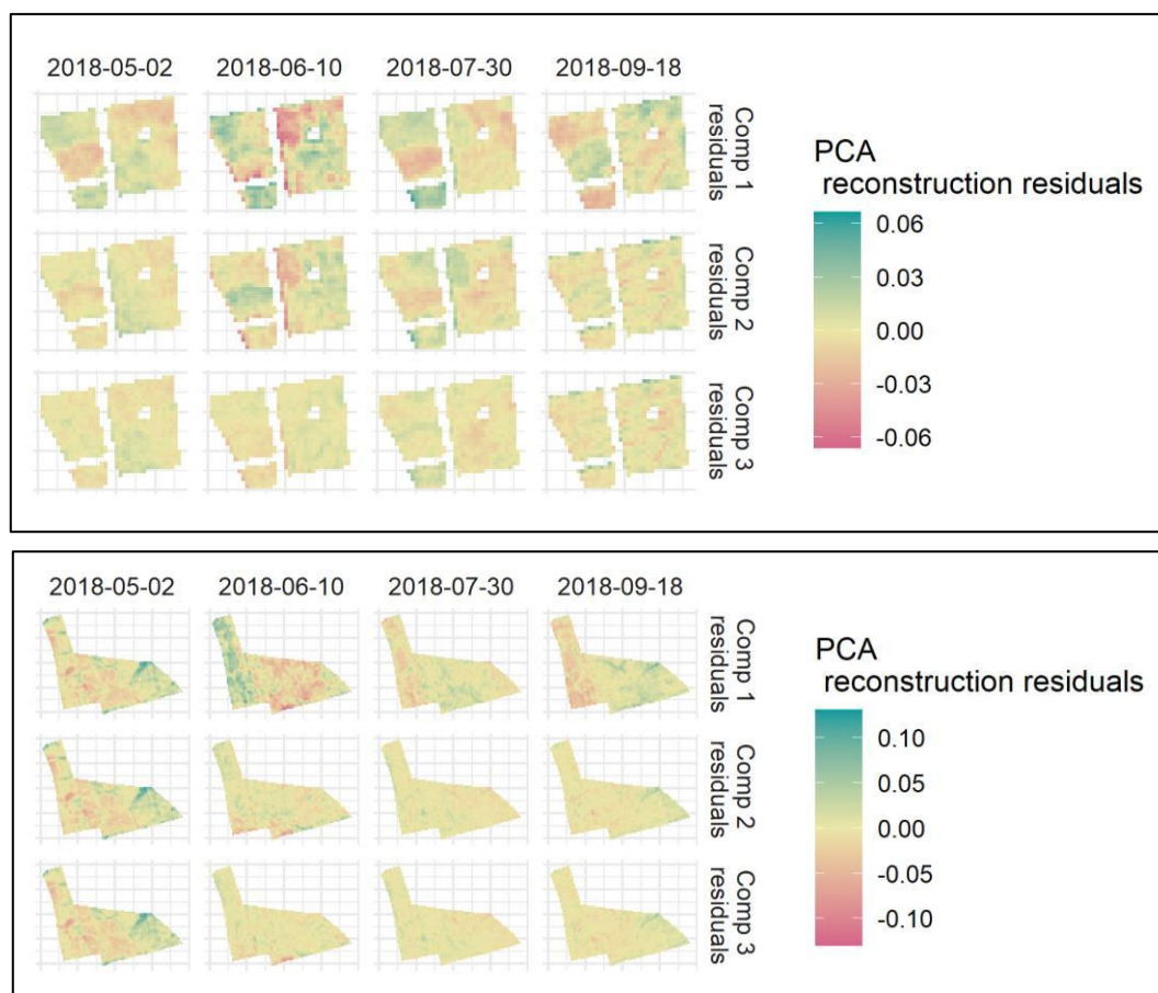
Figura 21 - Residuos locales obtenidos en diferentes fechas durante la reconstrucción del NDVI utilizando combinaciones de componentes del PCA. Arriba: Viñedo A; Abajo: Viñedo B. En cada imagen: fila superior: PCA 1, media: PCA 1 + 2, inferior: PCA 1 + 2 + 3.
